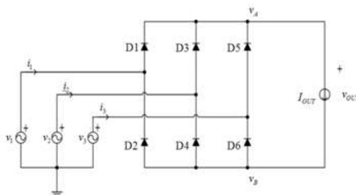
**Figure 3.2 Three phase diode rectifier**
