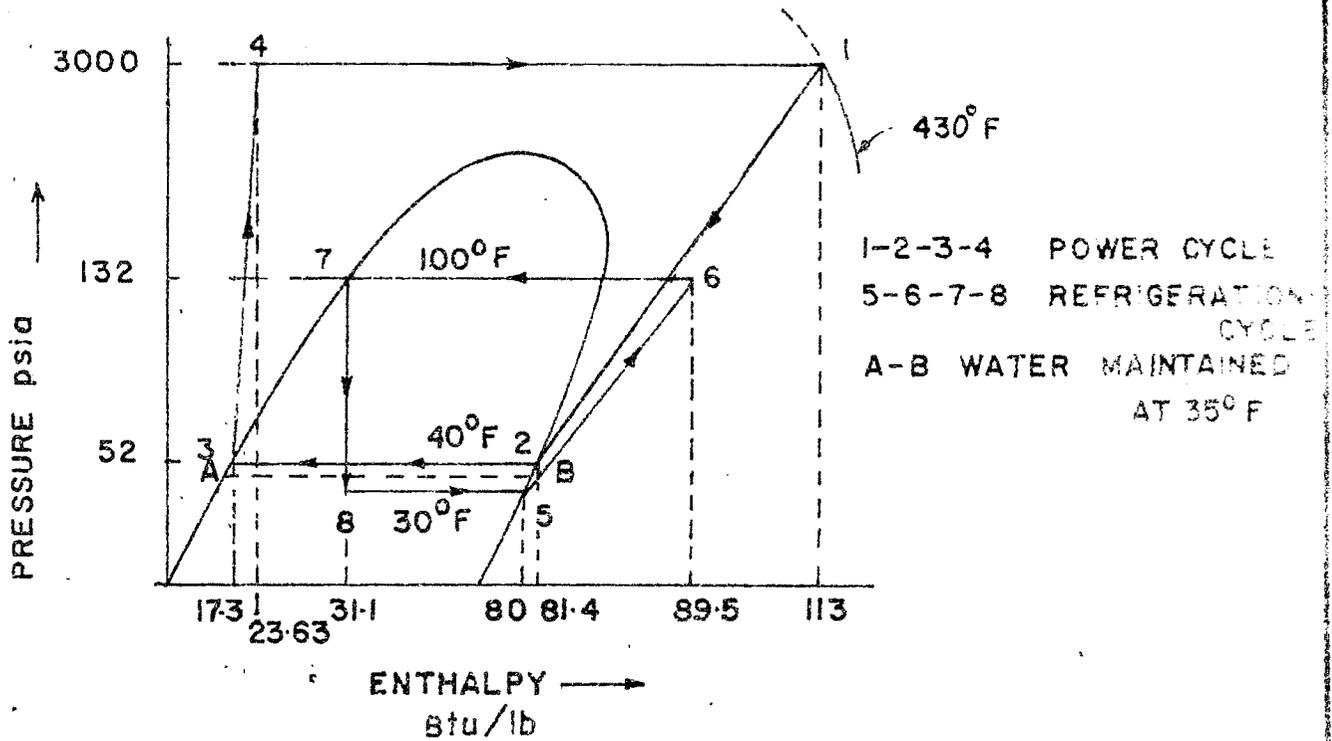
FIG. 3-5 COMBINED POWER AND REFRIGERATION CYCLE OF R 12
