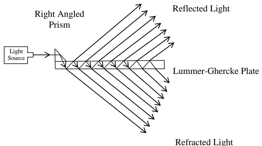
**Figure 1.7: Lummer-Ghercke Plate Interferometer**
